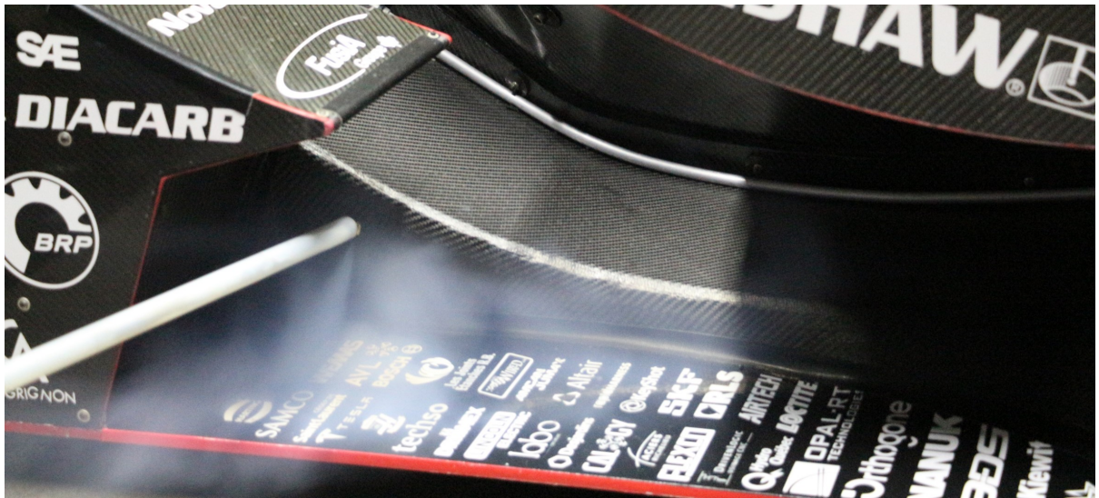
Figure 4.6 Visualisation par fumée de la recirculation sur le fond plat
