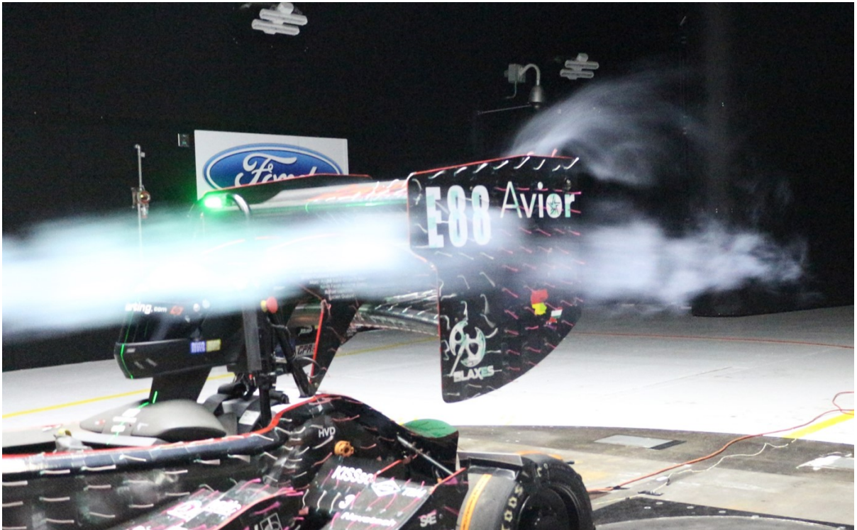
Figure 4.9 Visualisation du fluide au voisinage de l'aileron arrière
