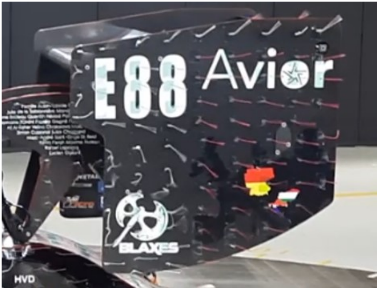
Figure 4.8 Visualisation d'un décrochage par la méthode du tufting
