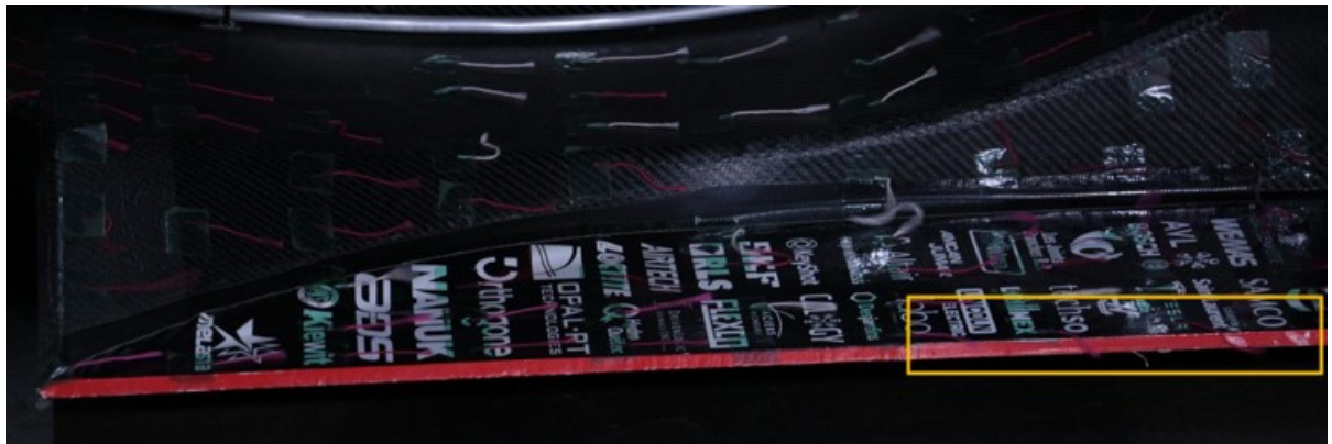
Figure 4.7 Echanges entre la partie supérieure et inférieure de la jupe
