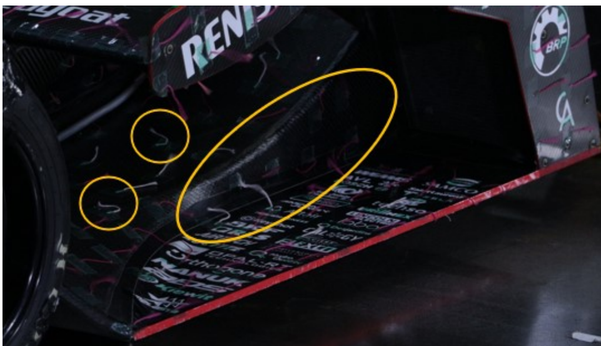
Figure 4.5 Photographie des tufts du fond plat
